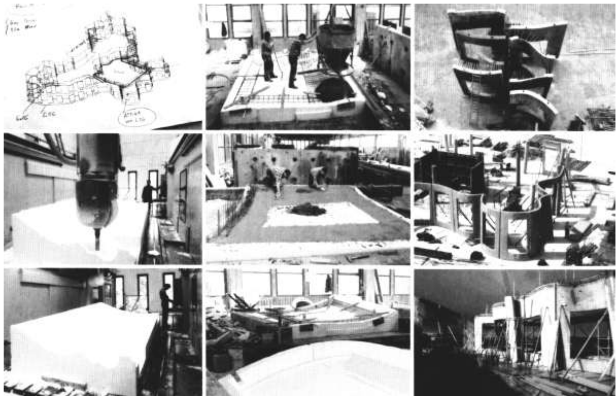
Abb. 35: Herstellung der Schalungsformen aus Styropor
